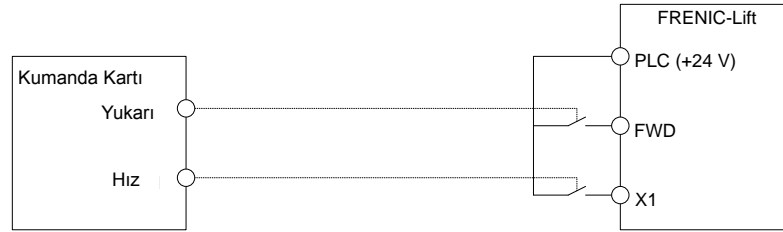
Şekil 6: Kumanda kartının kuru kontakları kullanılarak yapılan normal bağlantı
